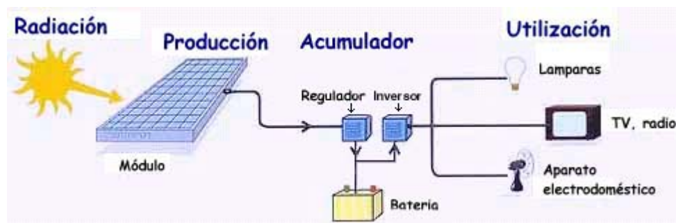
Una instalación solar fotovoltaica con inversor, utilización a 230Vca
