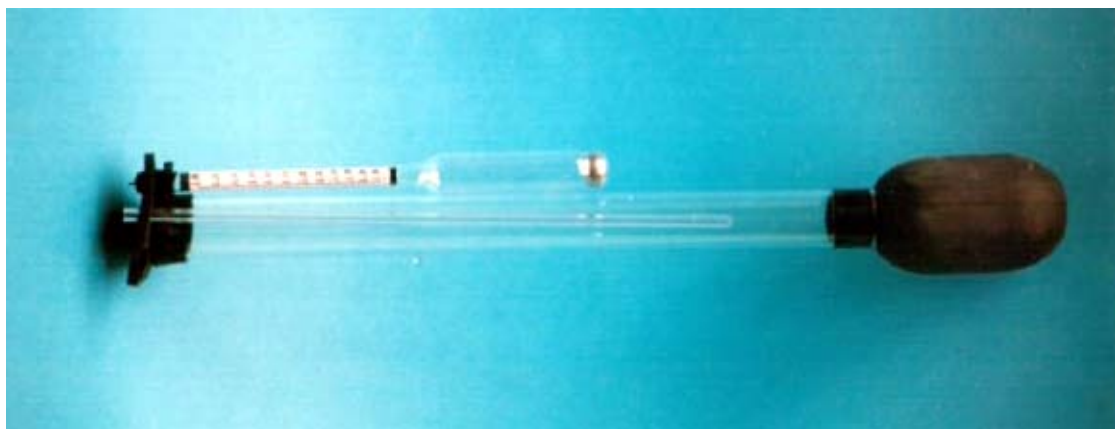
Un densímetro (sin ensamblar) de los usados en acumuladores estacionarios
